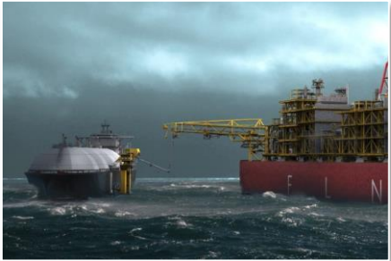
HiLoad LNG Parallel Loading System
